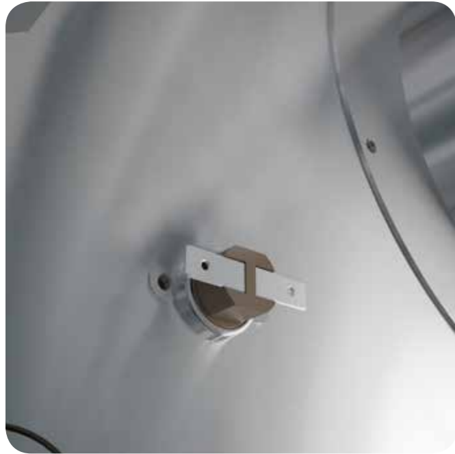
A. Doppia protezione. GDZ G-Wiz ha un termostato di sicurezza allo scarico per monitorare sempre la temperatura dei fumi oltre alla sonda di temperatura impostabile T2, gestita di serie dal controllo G-Wiz.
